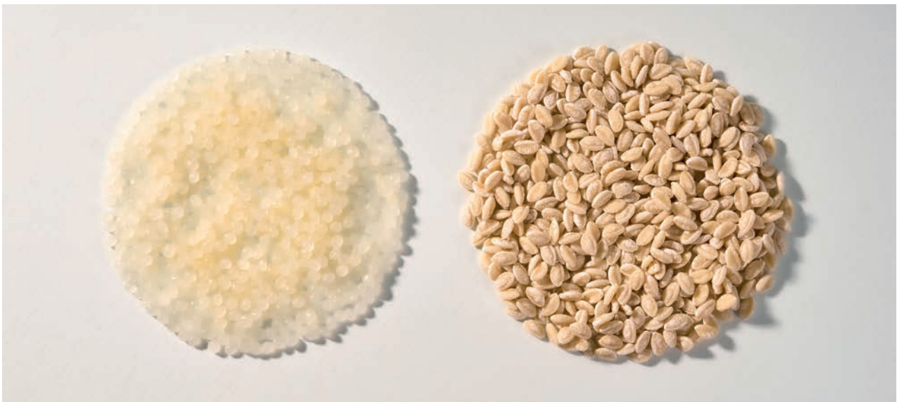
De gauche à droite : Pellets PLA et Masterbatch CARBIOS Active (Crédit : SkotchProd)
