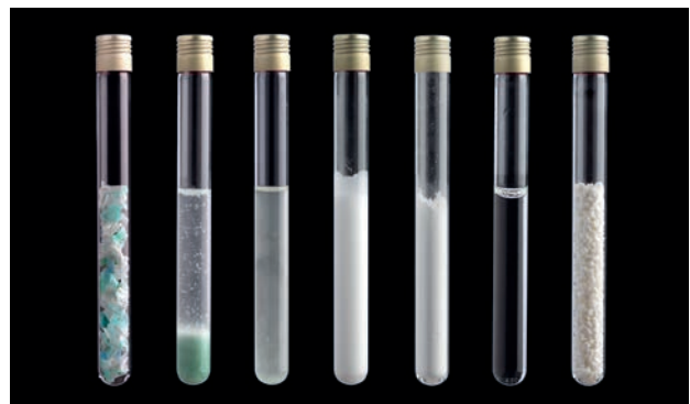
Dépolymérisation enzymatique de déchets plastiques PET en acide téréphtalique (AT) et mono éthylène glycol (MEG) au sein d'un réacteur d'hydrolyse et repolymérisation de ces monomères en PET, de qualité alimentaire, 100 % recyclé et 100 % recyclable (Crédit : Carbios).
