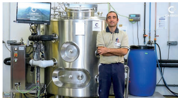
Réacteur de dépolymérisation de déchets plastiques et textiles PET en monomères de l'unité pilote de Carbios.
